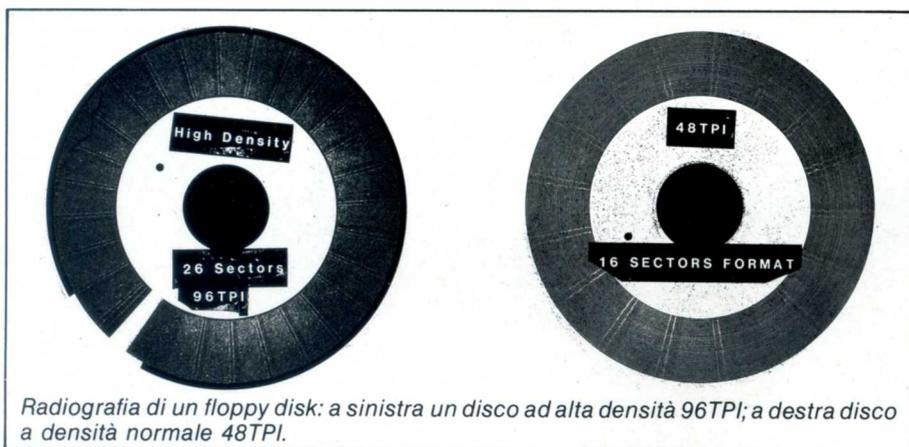
Radiografia di un floppy disk: a sinistra un disco ad alta densità 96TPI; a destra disco a densità normale 48TPI.
